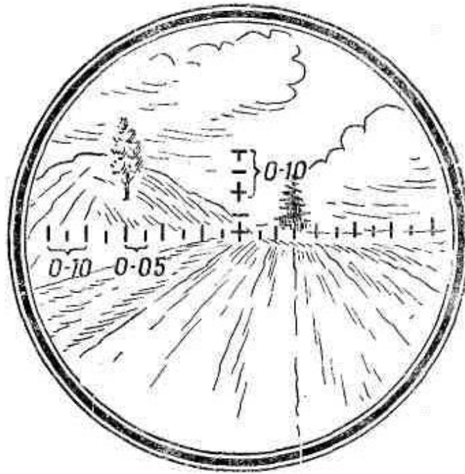
Рис.1. Измерение углов с помощью бинокля
