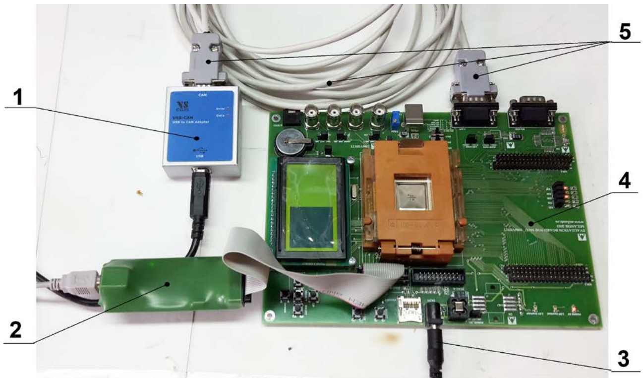
Рисунок 8.1 Лабораторная установка: 1- Преобразователь CAN-USB типа VS-COM; 2- Программатор TP-link (J-link); 3-Штеккер блока питания 5В; 4-Отладочная плата; 5- Кабель для подключения по интерфейсу CAN.
