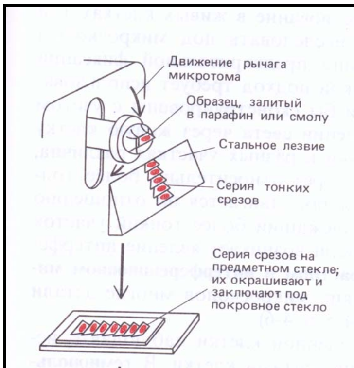
Рис. 1. Схема изготовления гистологических срезов с помощью микротомы. Залитый в парафин образец закрепляется в держателе на подвижном рычаге микротомы. Образующие ленту последовательные срезы остаются на лезвии ультратомы, откуда их перемещают на предметное стекло и подвергают дальнейшей обработке.
